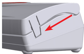
Slika 6: Prikaz zaključanog vakuumskeg aparata (sklopka je pritisnuta prema unutra)
