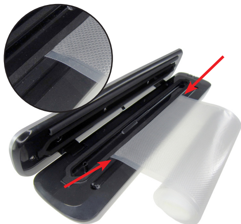
Slika 2: Pri varenju mora biti vrećica na varećem traku - do brtve, kako prikazuju strelice (ne preko nje).
