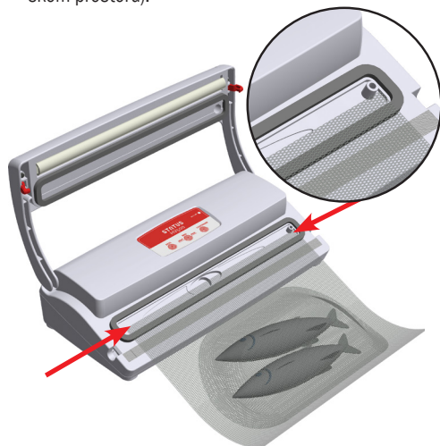
Slika 3: Pri vakuumiranju vrećica mora biti namještena između crnih brtvi.
