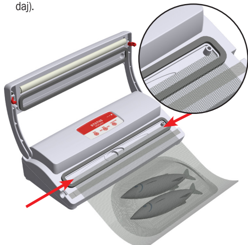
Slika 3: Pri vakuumiranju mora biti vrečka nameščena med črna tesnila.
