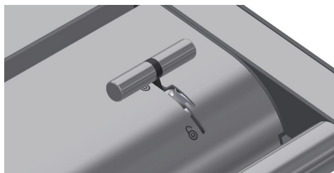
Slika 8: Tijekom ručnog vakuumiranja ručica mora biti u zaključanom položaju.
