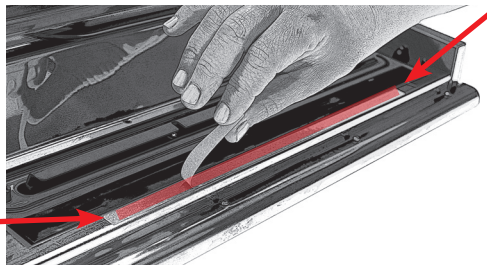
Slika 3: Prije namještanja dvostrane ljepljive trake neophodno je očistiti površinu aparata.
