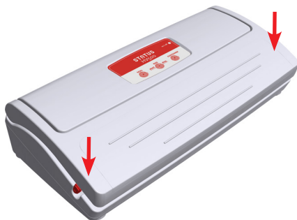
Slika 4: Vakuumski aparat zaklenete tako, da pritisnete na rob pokrova aparata (tam, kjer prikazuje slika) in zaklopko potisnete navznoter. Vsako stran posamezno ali obe hkrati.
