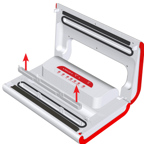
Slika 6: Ako tekućina uđe u vakuumski kanal, podignite posudicu ravno prema gore, izlijte tekućinu te dobro osušite posudicu.
